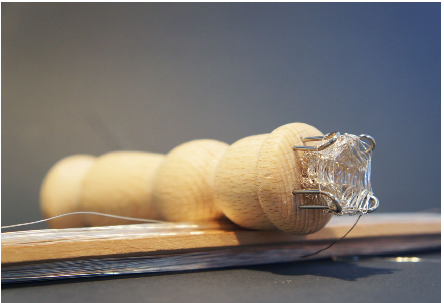
Abbildung oben: Drahtgewebe aus handelsüblichem Draht Abbildung unten: Drahtstricken mit der Strickliesel
